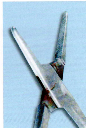
Foto 6: Corrosión por fisuración en un portaguja, el agujero alcanza todo el largo de la articulación.
